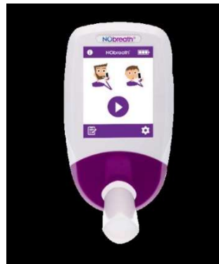
Figura 1: Monitor de óxido nítrico exhalado (FeNO) NObreath® (Bedfont Scientific Ltd., UK) utilizado en el estudio. La imagen muestra el dispositivo y su interfaz de usuario.
